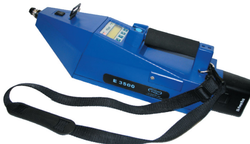
Figur 2.1 E3500 håndholdt eksplosivdetektor. Foto: Scintrex Trace
