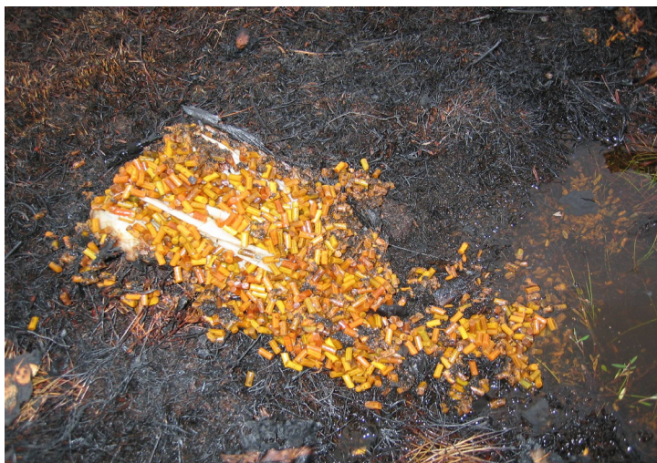
Figur F.2 Overskudd av drivladning forsøkt brent opp på standplass
