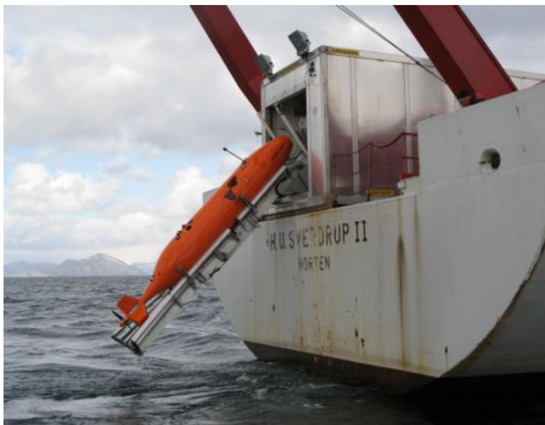
Figur 1.2 HUGIN HUS tas opp på akterdekket av FFI's forskningsfartøy HU Sverdrup II etter endt operasjon i Vestfjorden, mai 2008
