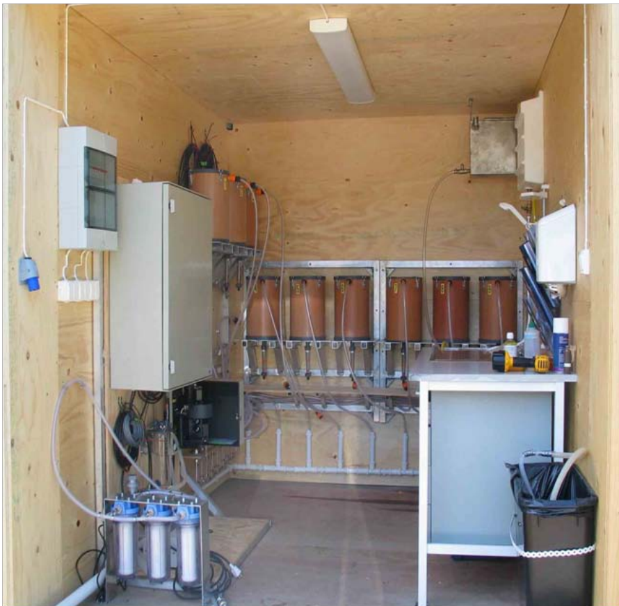
Figur 2.1 Bilde av feltlaben på Steinsjøen skytefelt med kolonneoppsett.
