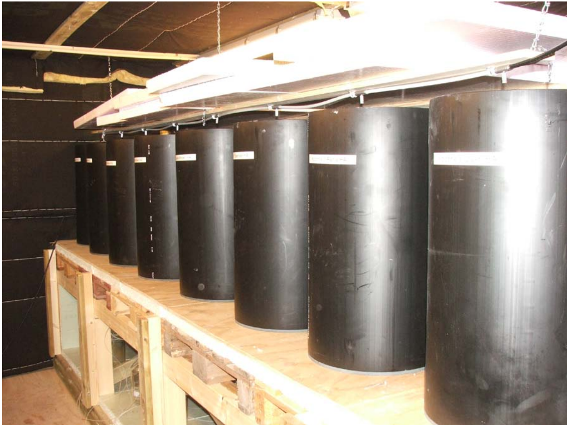
Figur 2.2 Kolonnene plassert på benkeplater inne i feltlaboratoriet. Hver kolonne var tilknyttet en dyse som spredde vannet i en tåkesky jevnt utover overflaten. I bunnen av hver kolonne ble det installert oppsamlingsflasker i glass (5 l) som var tilkoblet vakuumpumpe.
