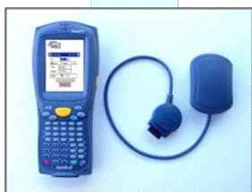
Håndholdte Pc'er med Savi Mobile RFID avlesere (SMR-650)
