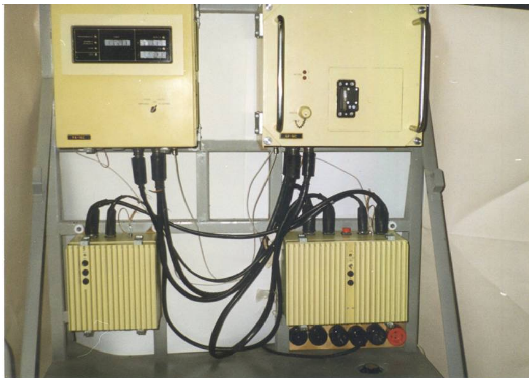
Фото 4. Термо-люминесцентное считывающее устройство КИД-08С, расположенное в здании Службы ядерной и радиационной безопасности на ФГУП 10 СРЗ.
