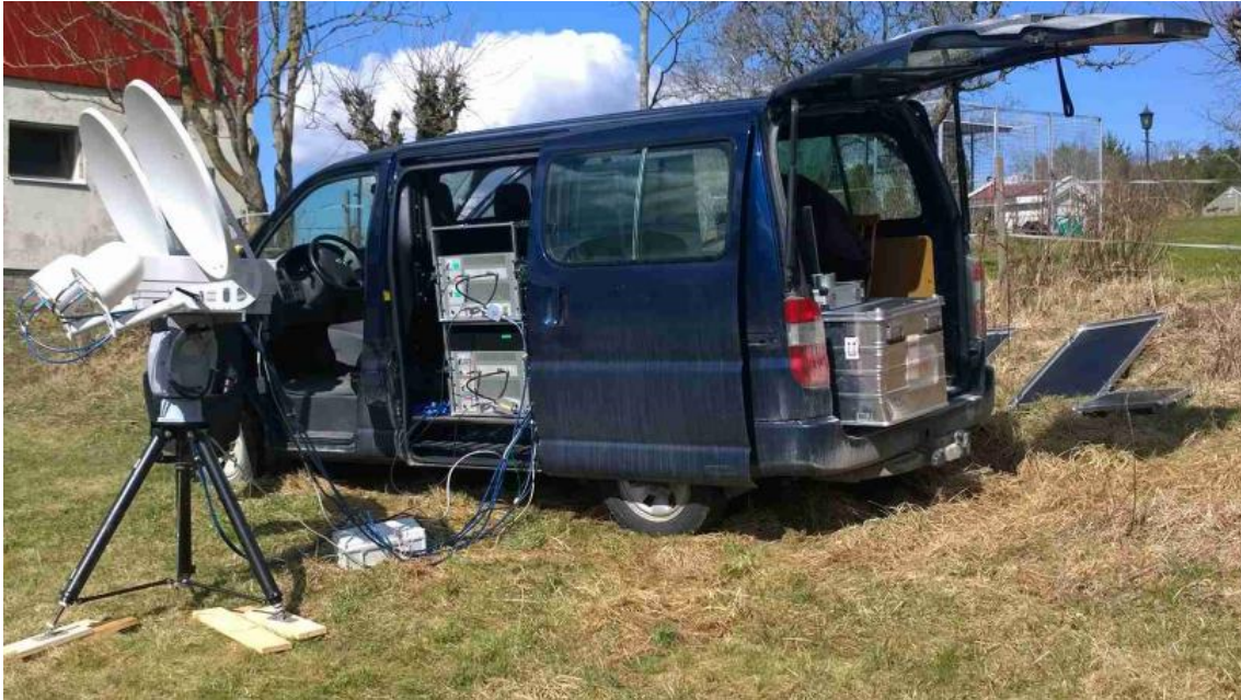
Figur 2.3 BirdRAD under måling av UAV. Varebilen huser sender, mottaker og prosesseringsrack. Antennene med kamera i mellom seg og den styrbare pidestallen er plassert på utsiden av bilen.
