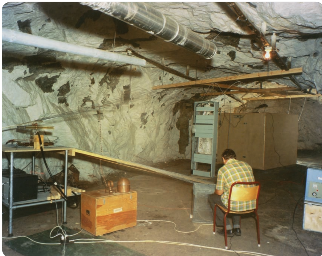
EMP fra kjernevåpen ødelegger ubeskyttet elektrisk utstyr. Bildet viser Karl-Ludvig Grønhaug i et testanlegg for EMP i 1972. I et fjellanlegg i Sørumsfjellet ved Lillestrøm ble samband og våpenutstyr utsatt for simulert EMP.
