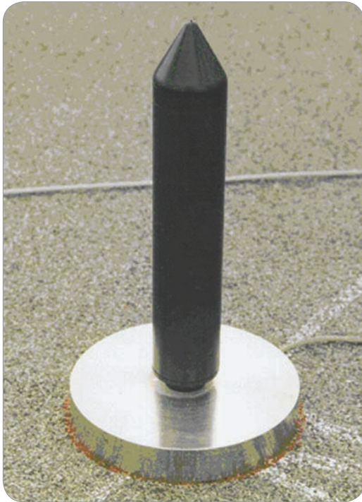
Akustisk detektor. (Mikrofon med værbeskyttelse).
