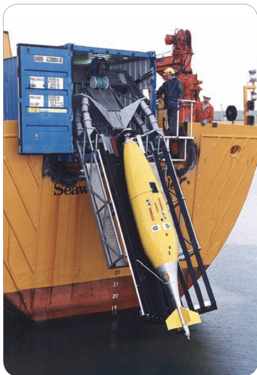
HUGIN I i launch- og recovery-systemet ombord på M/V Seaway Commander i juni 1997.
