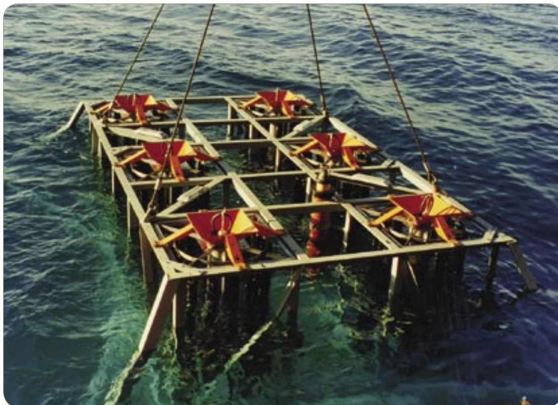
Sjøvannsbatteri under utsetting i det Joniske hav 1996. Kapasitet 650 000 Wh ved 30 W last.
