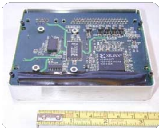
Enkoder basert på FPGA (Field Programmable Gate Array). Foto: Terje Angeltveit.
