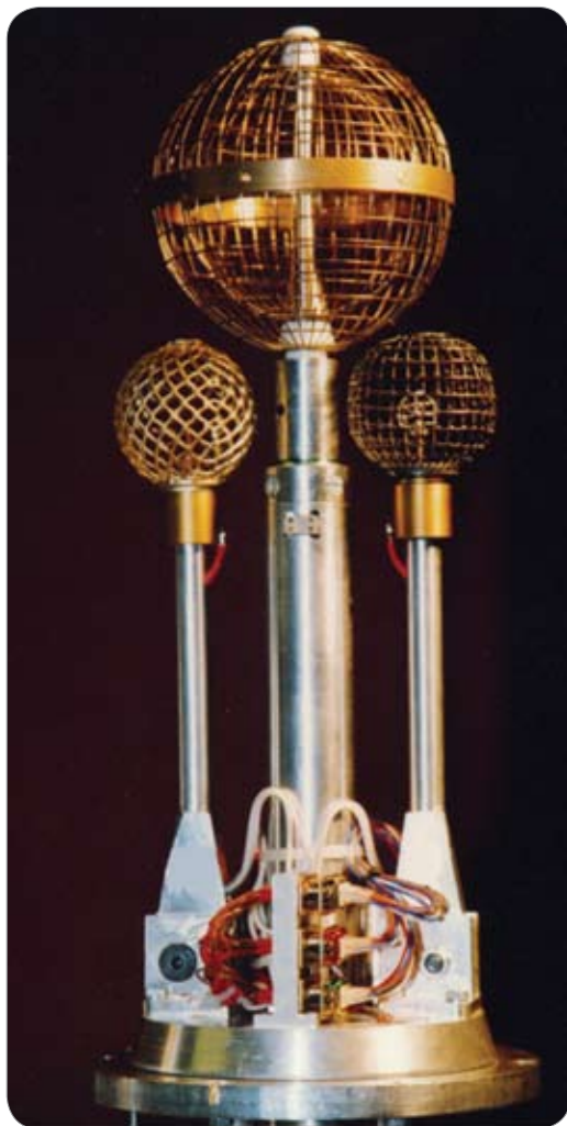
FFI-instrumenter i Isbjørn. I midten en positiv ionesonde. På sidene "kaldt plasmasonder". Foto: Terje Angeltveit.
