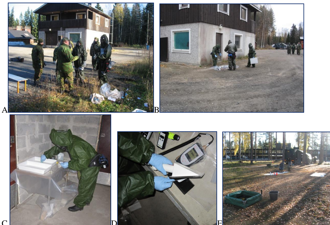
Figur 2.16 Undersøkelse av radiologiske kilder. A) Det ble benyttet reelle radioaktive kilder i øvelsen. Instruktørene var derfor nøye med å følge med på hva prøvetakingslaget gjorde. Det var observert radioactive kilder utenfor og inne i bygget. B) forberedelser til innpassering i huset. Området rundt var undersøkt med R-detektorer, C) en væske i karene ga svakt utslag på alfa stråling. Denne væsken ble tatt prøve av med filterpapir, D) filterpapiret ble nærmere analysert med Colibri TTC/GPS og HDS-100.
