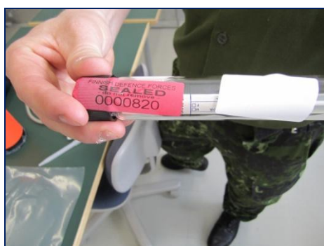
Figur 2.4 Forsegling og merking av prøver. Alle åpninger i prøveemballasjen (korker, ziplock etc) forsegles med forhåndsnummerert segl. I tillegg merkes prøven med prøvenummer (kap. 8 i NATO 2009).
