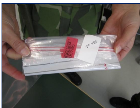
Figur 2.4 Forsegling og merking av prøver. Alle åpninger i prøveemballasjen (korker, ziplock etc) forsegles med forhåndsnummerert segl. I tillegg merkes prøven med prøvenummer (kap. 8 i NATO 2009).
