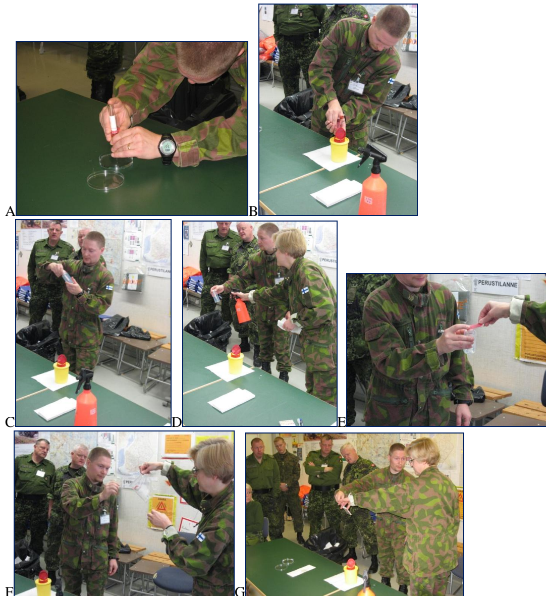
Figur 2.3 Prøvetaking av kjemisk væskeprøve. A) Prøvetaking med vakutainerglass, B) brukt kanyle legges i beholder for farlig avfall, C) vakutainerglasset legges i ny ren teflonflaseke etter rens, D) rens av teflonflasken, E) korken på teflonflasken forsegles, prøvetaker holder sine hender under hendene til assistenten, F) forseglet prøve overføres til ny ytre emballasje, G) avlesning av pH i væsken vha pH-papir.
