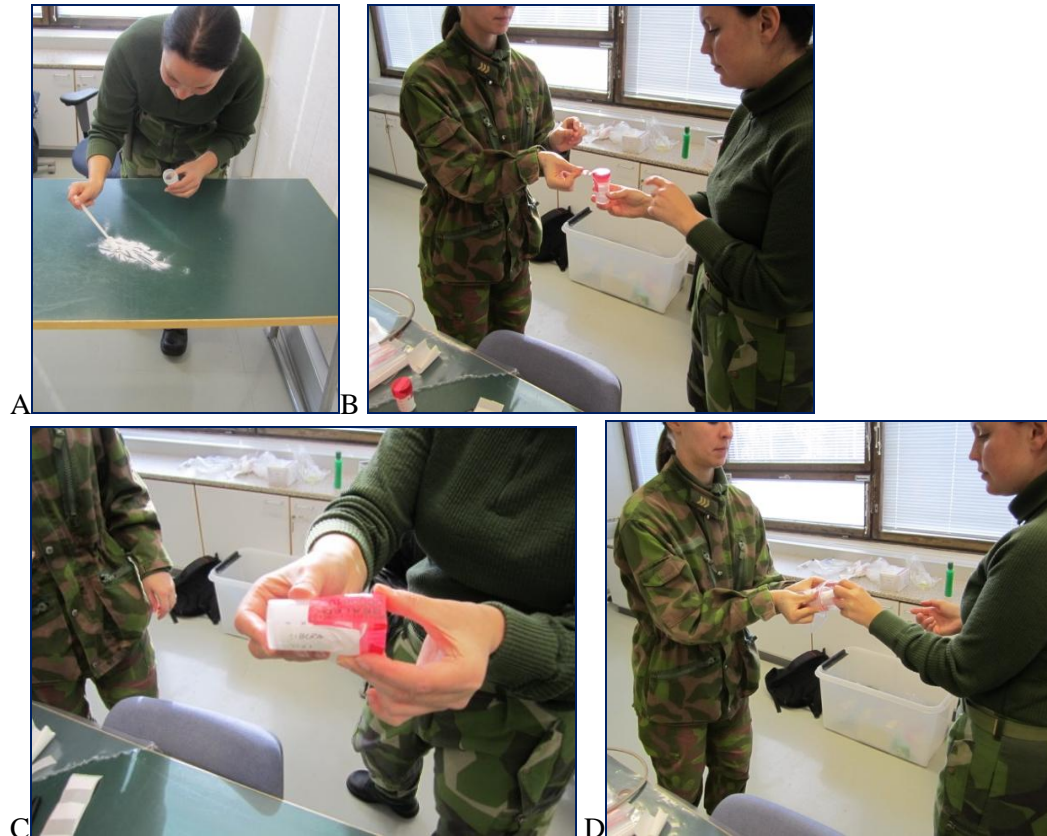
Figur 2.13 Samarbeid mellom prøvetaker og prøvetakers assistent. A) Prøvetaking av pulver, B) påføring av forsegling, C) forseglet prøve med ID nummer, D) overføring av merket prøve til ren emballasje fremholdt av assistenten. Bildene tatt under den praktiske klasseromsundervisningen under SIBCRA kurset.
