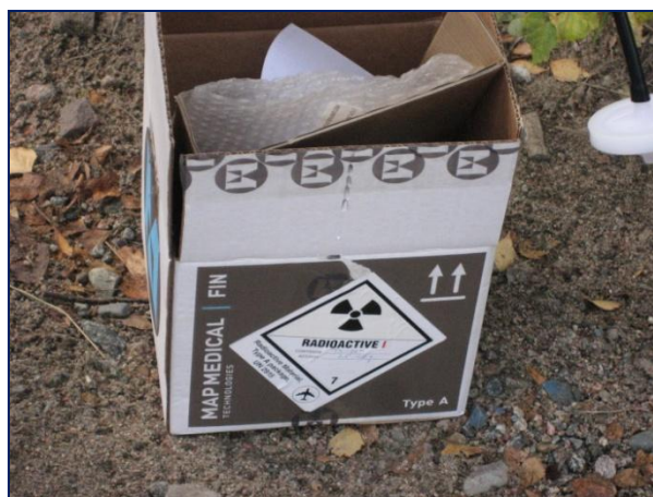
Figur 2.17 Emballasje til transport av radioaktive kilder til medisinsk bruk. Esken hadde inneholdt technetium ( Te -99 ).
