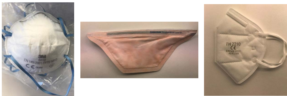
Figur 2.1 Tre ulike typer filtrerende halvmasker. Foto: FFI
