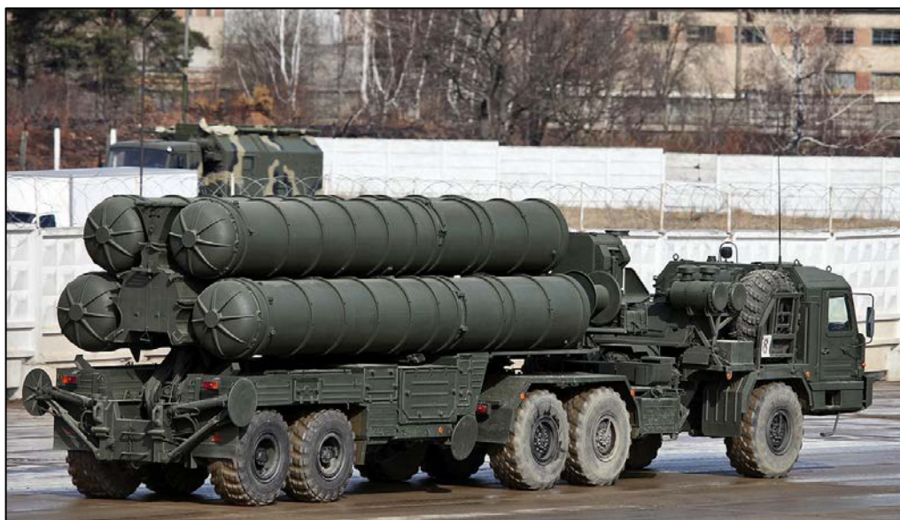
Figur 3.7 TEL for SA-21 Growler (S-400) fotografert i 2014. De fire utskyttingsrørene reises opp som én enhet før utskyting. (Foto: Vitalij V. Kuzmin, lisensiert under Creative Commons Attribution-Share Alike 4.0 via Wikimedia Commons.)
