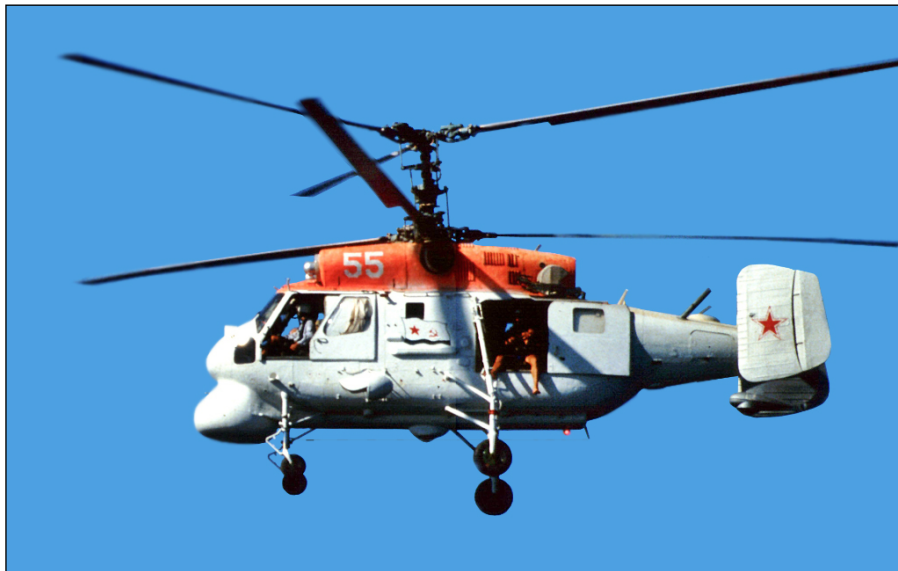
Figur 5.6 Et Kamov Ka-25-helikopter fotografert i 2018. Helikopteret har dobbelt sett med propeller. (Bilde fra U.S. Navy via Wikimedia Commons, offentlig eiendom.)
