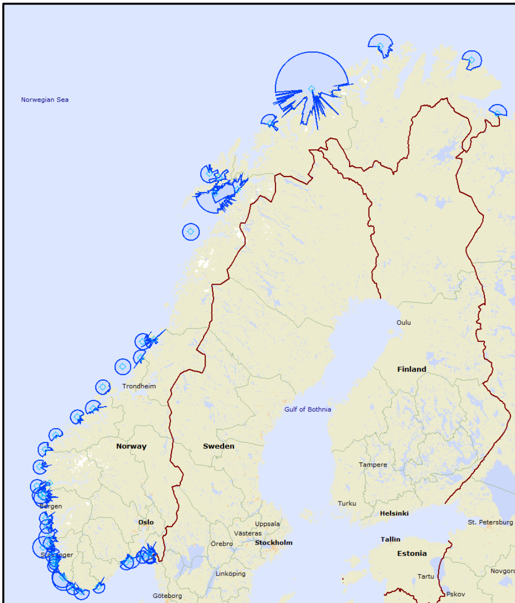
Figur 9.2 Oversikt over dekning og plassering av de gamle kystmelderadarene. Ved flere av disse stasjonene er disse radarene byttet ut med Kystverkets egne radarer. Disse stedene kan være aktuelle ved en utplassering av nye landbaserte overvåkingsensorer (for eksempel LINE/NRD).
