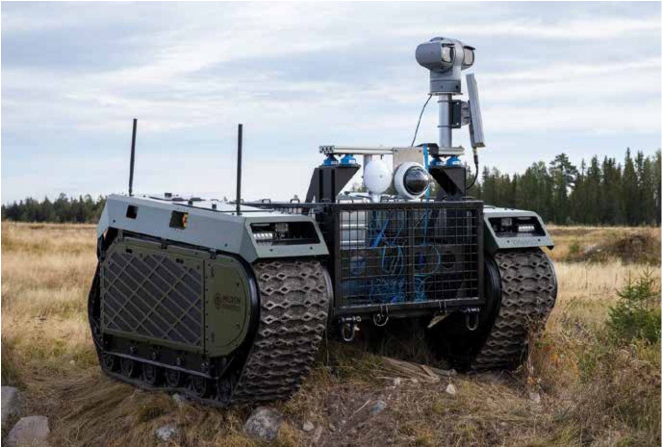
Et ubemannet kjøretøy med radar og pan-tilt-zoom-kamera brukes for å gi operatøren i stridskjøretøyet bedre oversikt. Foto: Espen Wang-Naveen / FFI
