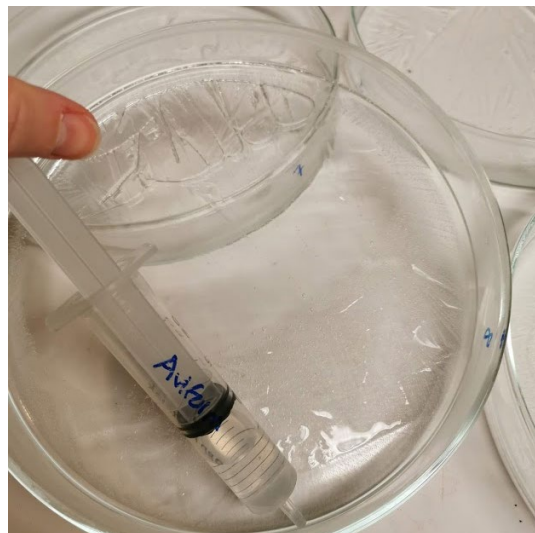
Figur 2.2 Smeltetestene i laboratoriet ble utført i skåler med ca. 3 mm tykk is. Skålene ble plassert i klimakammer justert til ønsket temperatur. Volumet smeltevann ble avlest ved gitte tidsintervaller.
