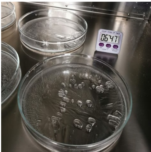
Figur 2.2 Smeltetestene i laboratoriet ble utført i skåler med ca. 3 mm tykk is. Skålene ble plassert i klimakammer justert til ønsket temperatur. Volumet smeltevann ble avlest ved gitte tidsintervaller.
