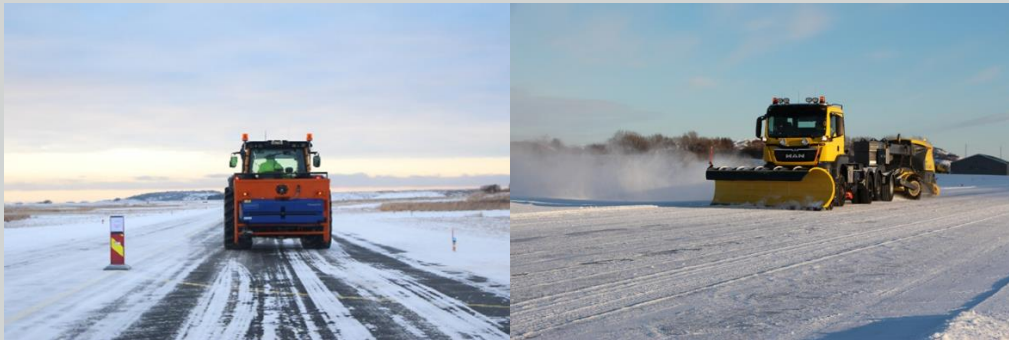
Baneavising på rullebane ved påføring av avisingsmidler (t.v.) og mekanisk fjerning (t.h). Foto: Forsvaret
