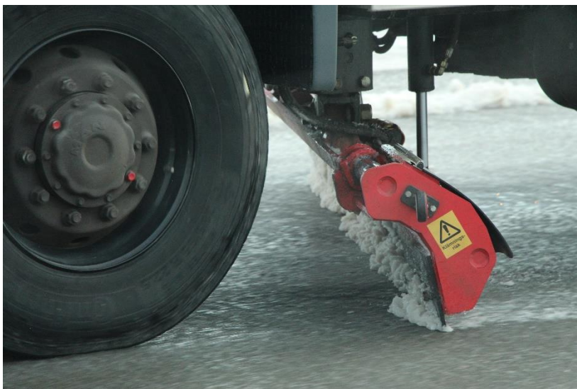
Figur 2.6 Høvling av is på rullebanen med isskjær/bukskjær.
