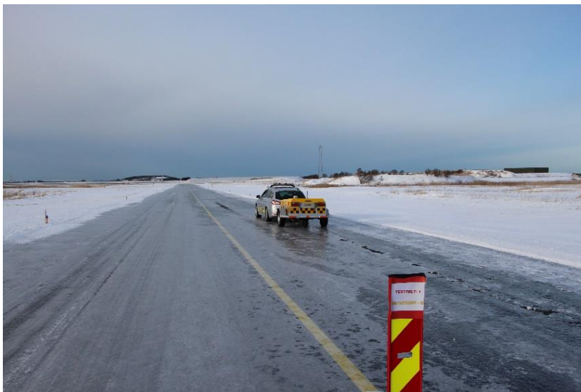
Figur 2.3 Kjøretøy med målehjul for måling av friksjon.
