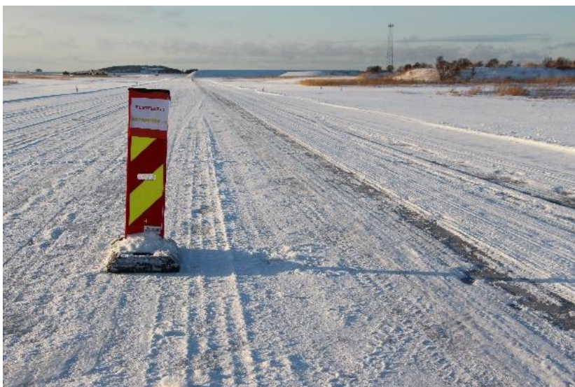
Figur 3.7 Forholdene på testfeltene før test 6. Snøen/isen ble ikke fjernet i forkant av testen for å utfordre avisingsmidlene mest mulig.
