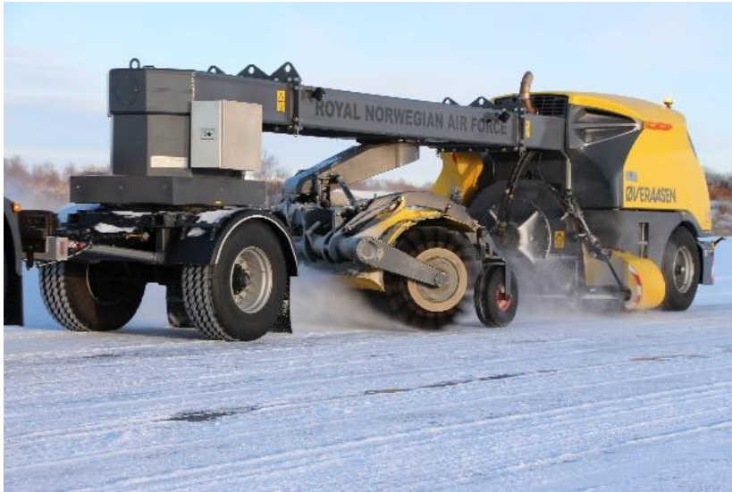
Figur 2.5 Feiing/børsting av rullebanen med stålbørste.
