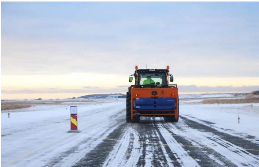
Figur 2.2 Utlegg av avisingsmiddel med ATV for testen i 2020 (øverst) og utstyr som ble brukt for testene i 2021(nederst).
