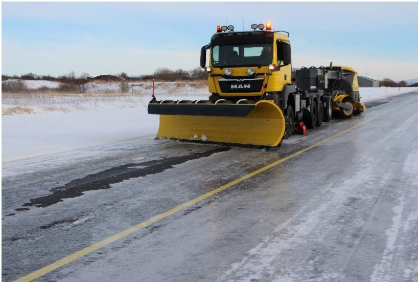
Figur 2.4 Brøyting av rullebanen med plog ved ulike forhold.
