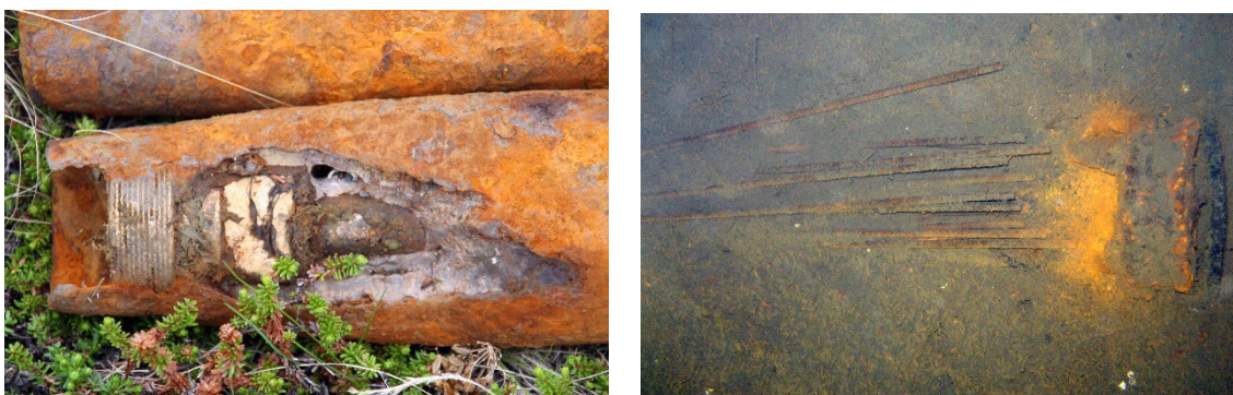
Figur 6.1 Til venstre en korrodert granat hentet opp fra et dumpeområde i sjø med blottlagte eksplosiver. Til høyre en artillerihylse på bunnen av Oslofjorden som er korrodert slik at drivladningen er blitt synlig. Foto: FFI.
