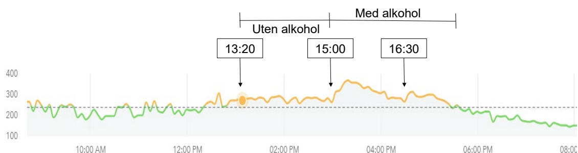
Figur 3.8 Resultatet fra laboratorieeksperimentet «omvask» hvor en person benytter først EffectDes (uten alkohol) og deretter Antibac 75 prosent etanol (bokser angir påføringstidspunkt). Resultatet i VOC-nivå leses av hvert femte minutt. Når streken er gul er VOC-nivået over 250 ppb.
