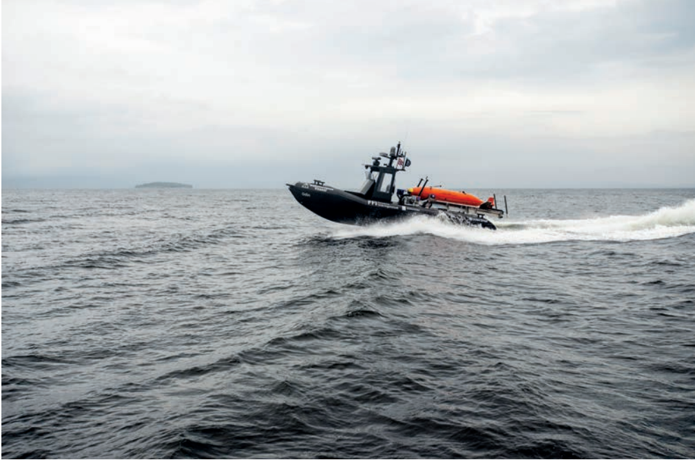
◀ FFIs førerløse forskningsbåt Odin sammen med den autonome undervannsfarkosten (AUV) Hugin. Hugin kan operere på egen hånd ned til 6000 meters dyp, uten fysisk forbindelse til en båt eller fjernkontroll fra overflaten. Foto: FFI
