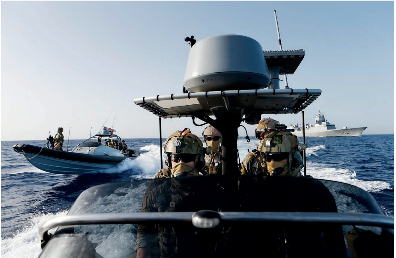
Norske marinejegere i aksjon under Operation Ocean shield i 2013. Bredbåndsantenna fra Radionor er den taggete boksen på «taket». Foto: Torbjørn Kjosvold / Forsvaret
