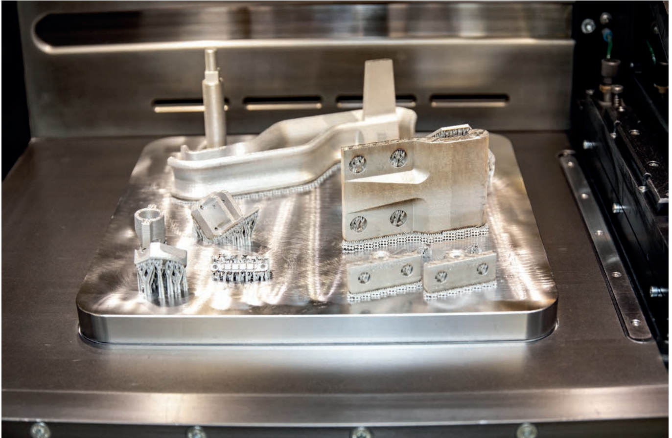
Innenfor additiv tilvirkning er det sju «familier» av fremstillingsmetoder. Disse reservedelene er fremstilt i en av Fieldmades Lasertec-printere. De benytter seg av teknologien Powder Bed Fusion. Delene på bildet ligger i kammeret der de nettopp er laget. Foto: Lars Aarønæs / FFI
