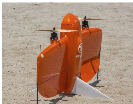
Figur 4.1 Eksempel på tailsitter konfigurert som flygende vinge med to motorer. Bildet er hentet fra [3]
