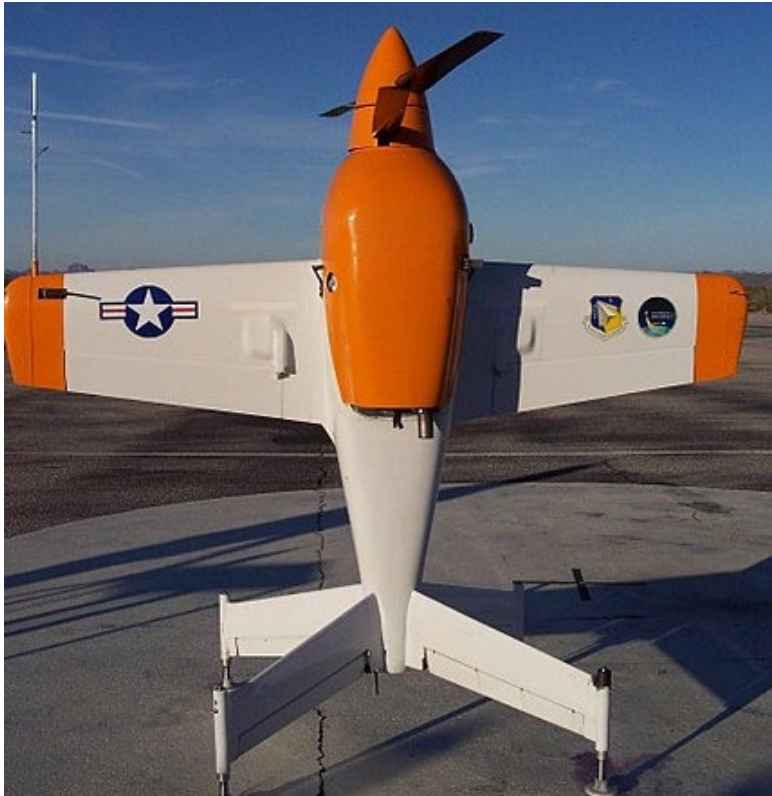
Figur 4.4 AeroVironment SkyTote har to konttaroterende propeller i nesa med cyclic funksjon for pitch- og yaw-kontroll. X-hale med rorflater for pitch- og yaw-styring ved vanlig fixed-wing-flyging og som bidrag ved VTOL-modus. Styring om lengdeaksen (fw-roll) skjer ved differensiert pådrag på de to propellene, og i tillegg er balanserorene på vingene plassert slik at de antagelig gir noe rollvirkning også i VTOL-modus.
