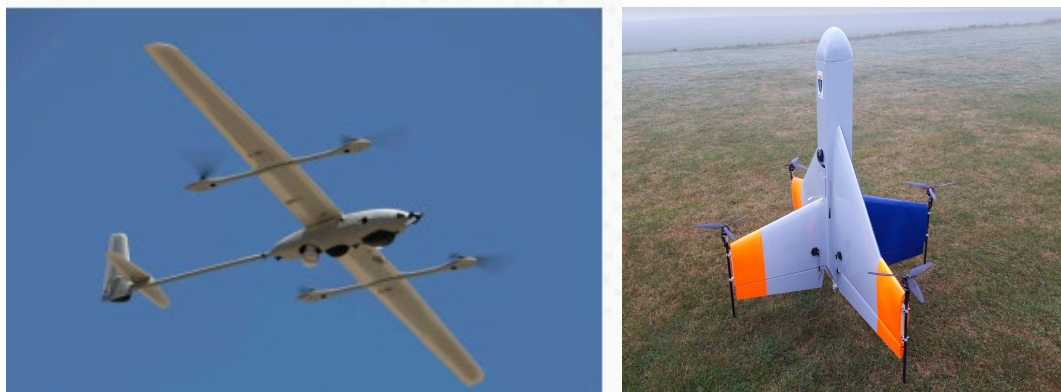
Figur 2.1 Eksempel som viser grunnleggende forskjell mellom horisontal VTOL-hybrid med fire VTOL-motorer og en fremdriftsmotor (Stalker VXE30), og tailsitter med fire motorer (FFI Interceptor-demonstrator)
