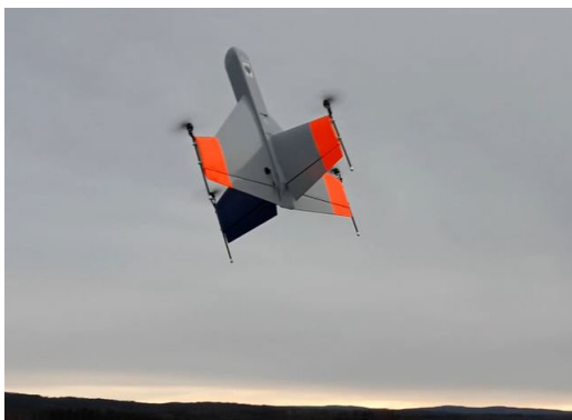
Figur 4.2 FFI's Interceptor-demonstrator er et eksempel på en tailsitter som er en kryssning mellom multi(quad)copter og semi-symmetrisk fixed wing farkost
