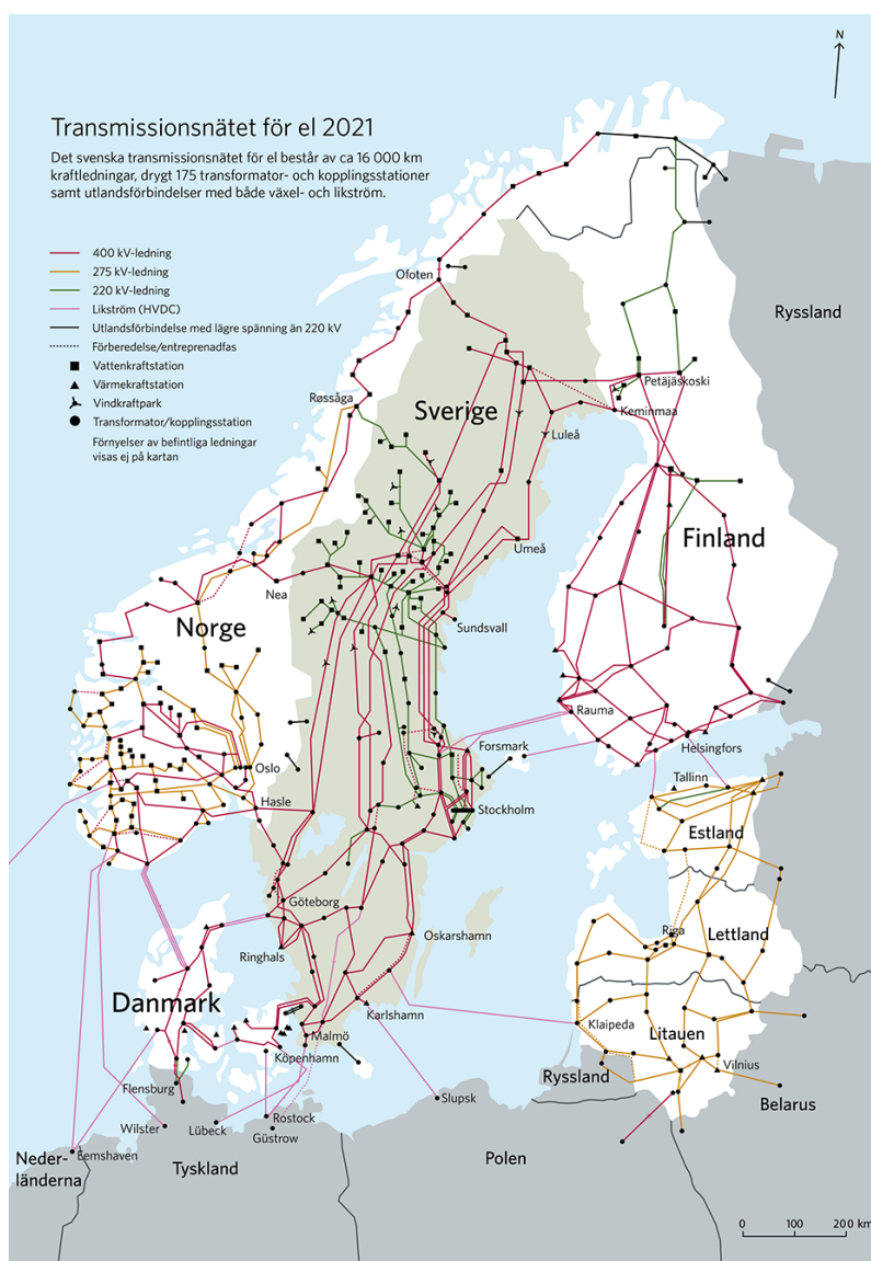
Figur 3.4 Transmisjonsnett i Norden i 2020. Illustrasjon: Svenska Kraftnät
