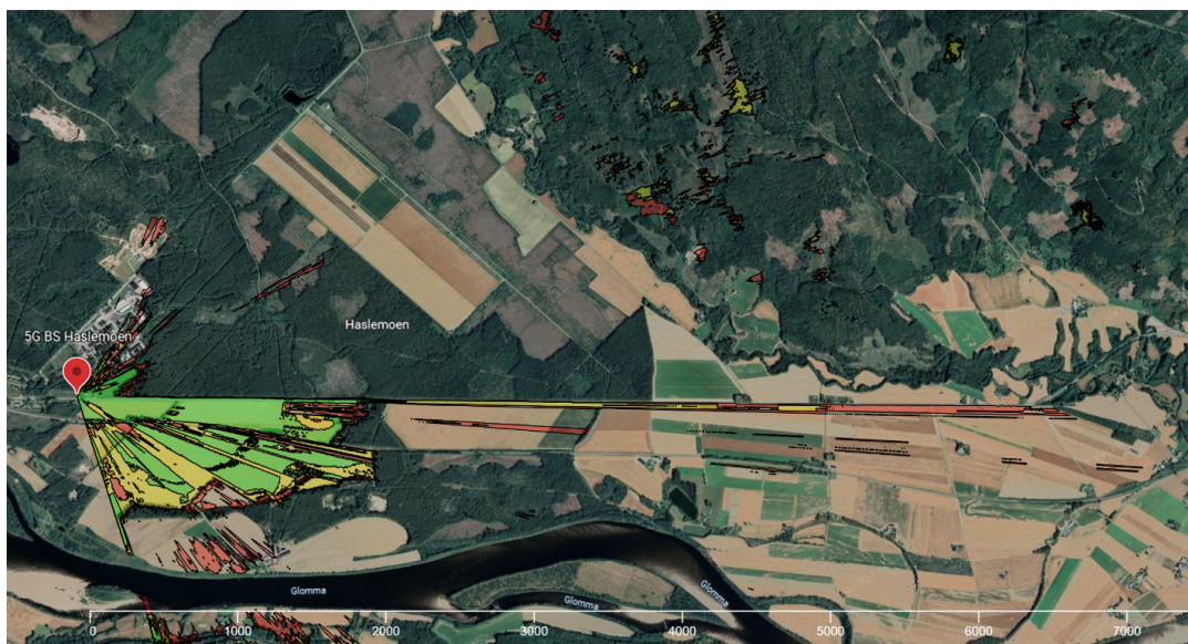
Figur 4.14 Et eksempel på dekningskart. Dekningskartet gjelder en pikocelle der basestasjonens høyde er på 10 meter over bakken. Målestokken er gitt i meter.
