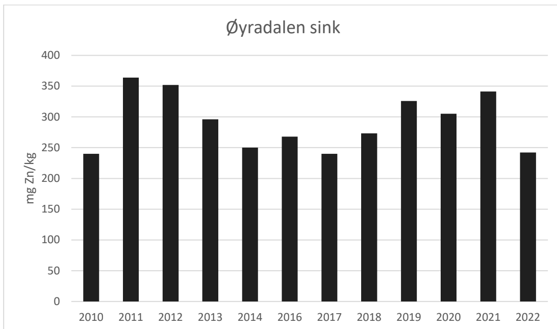
Figur 3.5 Gjennomsnittskonsentrasjon av sink i demoleringsfeltet i Øyradalen (9 prøvepunkter) fra 2010 til 2022.
