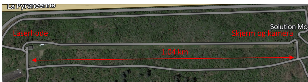
Figur 2.2 ONERAs 1 km lange bane ved senteret i Fauga-Mauzac sør for Toulouse. En 1 µm og 2 µm laser til venstre i bildet sendte lys over til en skjerm 1 km unna, til høyre i bildet. Foto: Google Maps.
