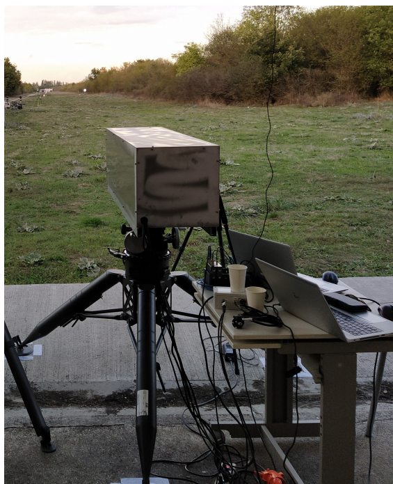
Figur 2.5 Laserhodet på stativ med utsikt nedover banen. På bordet bak laserhodet kan skimtes Compact real time IO enheten som ble benyttet for GPS-synkronisering og trigging av laseren. Foto: ONERA.
