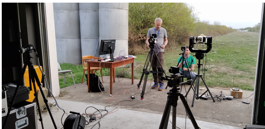
Figur 2.8 Kameraene for avbildning av laserstrålen. Fra venstre til høyre: FFI's 1 \mu\text{m} (SWIR) kamera, FFI's 2 \mu\text{m} (MWIR) kamera, ONERAs 1 \mu\text{m} kamera, Tübitaks single-piksel kamera (som ser direkte inn i laserstrålen), og Tübitaks 2 \mu\text{m} kamera. Foto ved ONERA.
