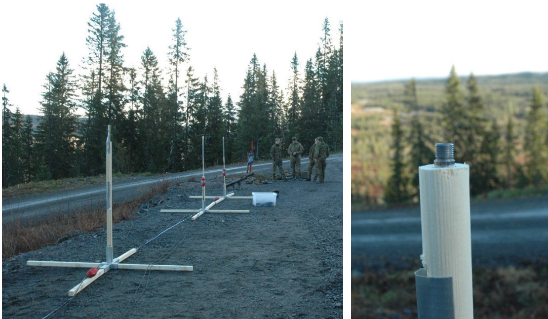
Figur 3.4 Oppsatt sensorrekke for \angle 90^\circ til venstre og nærbilde av sensorplassering i rundstokk til høyre.
