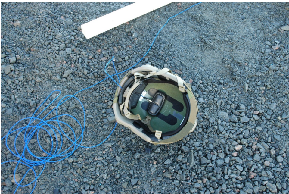
Figur 3.5 Instrumentert hjelm med trykksensor.
