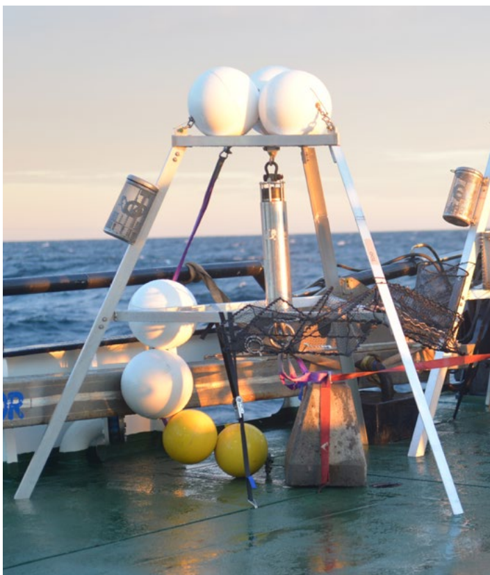
Stativene som ble satt ut på bunnen var påmontert skjellteiner, bur med passive prøvetakere, en tom kurv for svamp og en strømningsmåler. Rammene hadde også oppdriftskuler og sementblokker som lodd, pluss akustiske utløsere.
