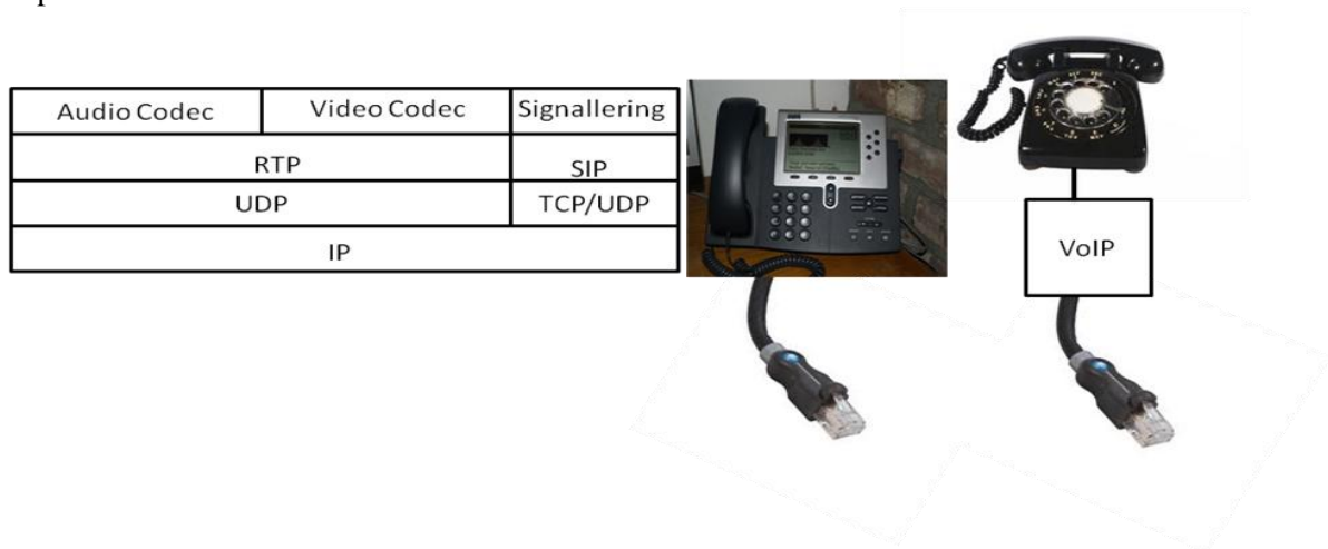
Figur 2.1 Tilkobling av endeutstyr til IP-nett via VoIP-leverandør
