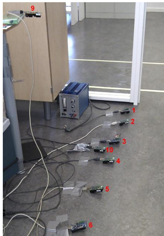
Figur 3.2 Testoppsett bestående av FTSP noder (1-6), beacon-node (9) og sniffer-node(10).
